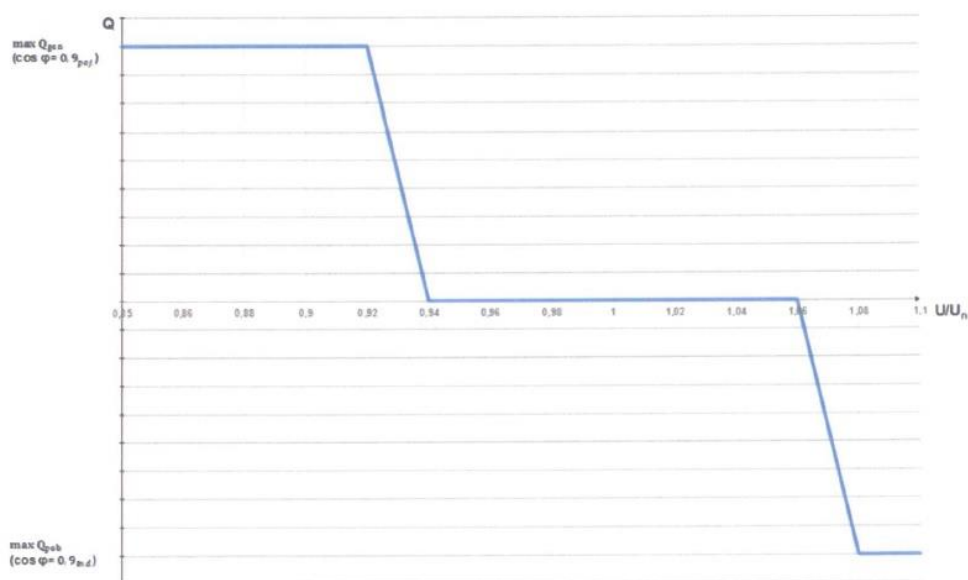
Rys.2. Charakterystyka sterowania mocą bierną w funkcji napięcia wymagana przez Energoserwis Kleszczów
