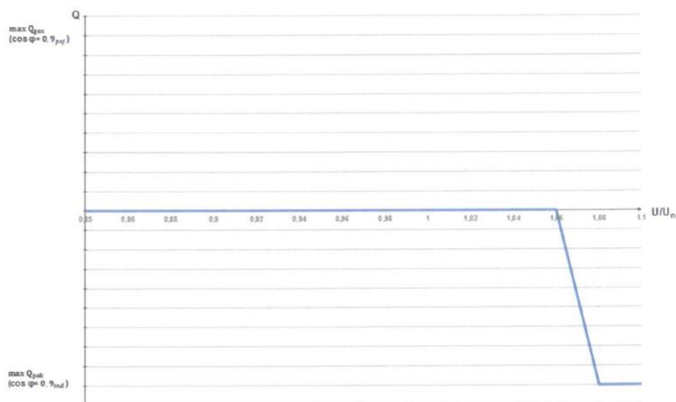
Rys. 3. Charakterystyka sterowania mocą bierną w funkcji napięcia dla mikroinstalacji podłączonych jednofazowo, wymagana przez Energoserwis Kleszczów
